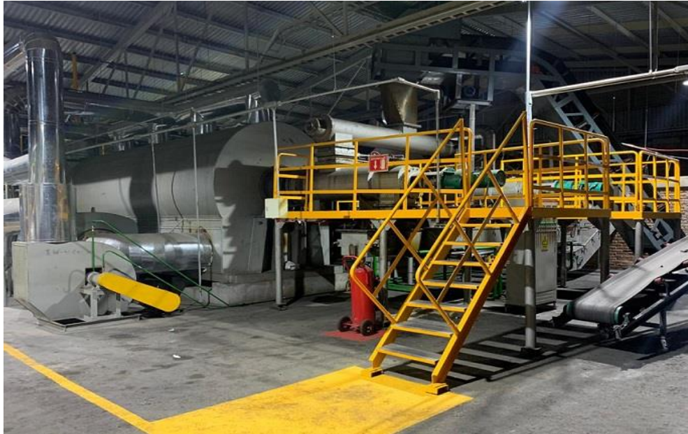
Figura 09 - Pirólise 8 ton/dia para produção combustíveis e carbon black . Pirólisis Latioamérica.
